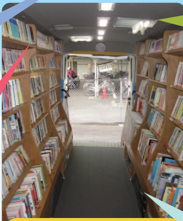
車内は人がすれ違えるよう、本棚の形を工夫しています。また棚板の角度は、本が落ちないように10度も傾いています。
